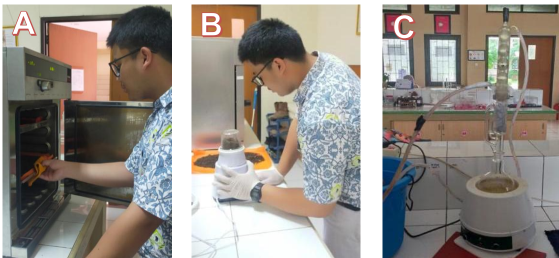
Gambar 1. Proses pengeringan maggot (A), pembuatan tepung maggot (B), ekstraksi minyak maggot dengan Soxhlet (C)
